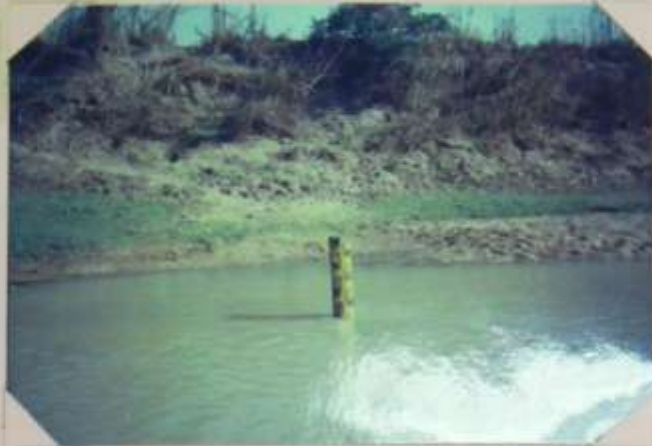
รูปถ่าย สถานีวัดน้ำ สถานี ๑ (๐.๐๐-๑.๐๐ ม.) ฝั่งซ้ายของแม่น้ำ ซึ่งใช้เพื่อวัดระดับน้ำ และค่าการไหลในแม่น้ำ
