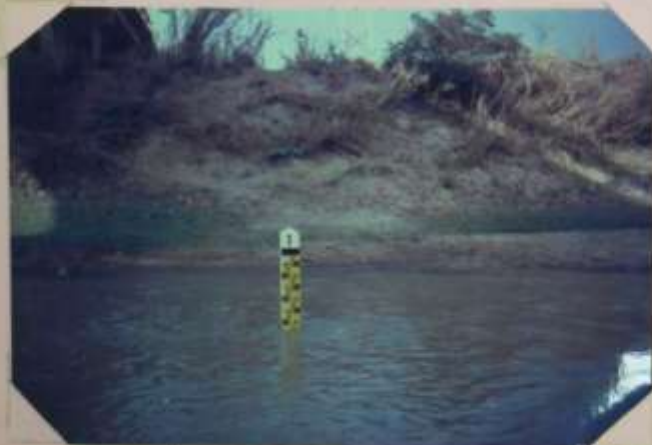
รูปถ่าย สถานีวัดน้ำ สถานี ๓ (๐.๐๐-๑.๐๐ ม.) ฝั่งซ้ายของแม่น้ำ ซึ่งใช้เพื่อวัดระดับน้ำ และค่าการไหลในแม่น้ำ
