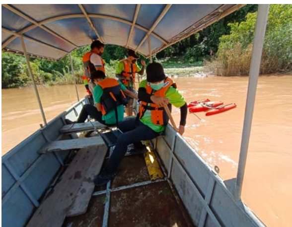
ขณะทำการสำรวจโดยใช้เครื่องมือ Acoustic Doppler Current Profiler (ADCP) : River Ray
