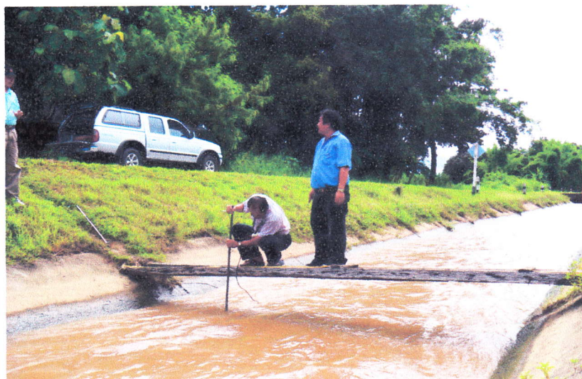
รูปที่ 10. แสดงการตรวจวัดปริมาณการไหลของน้ำตามมาตรฐานกรมชลประทาน
