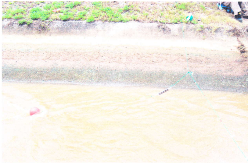
รูปที่ 11. แสดงการติดตั้งอุปกรณ์วัดกระแสน้ำโดยทุ่นวัดแรงเฉือนการไหล
