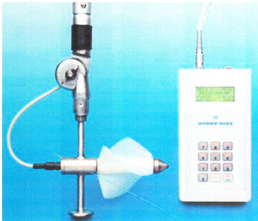
รูปที่3. แสดงเครื่องมือวัดความเร็วน้ำใบพัดขนาดใหญ่ (ใช้กรณีปริมาณน้ำมาก)
