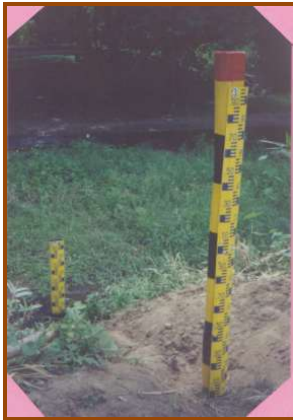
เสาระดับน้ำต้นที่ 2 1.00 – 3.00 ม. หลังจากติดตั้งเสร็จเป็นไม้เนื้อแข็งอยู่ฝั่งซ้ายของลำน้ำ
