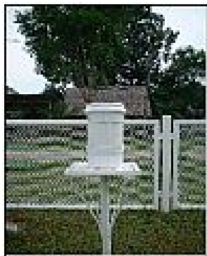
รูปที่ 2 ถังวัดน้ำฝนแบบธรรมดา ของกรมชลประทาน
